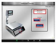
Al iniciar la aplicación Scale Link deberá colocar en la dirección IP de la báscula en la sección:
