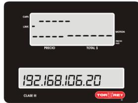
3.2.1.- por defecto la dirección IP es la 192.168.106.20 con las flechas de dirección puede desplazarse entre los dígitos, se dará cuenta en qué posición esta porque el número se mostrará de manera intermitente (aparecerá y desaparecerá) en ese momento puede sustituirlo utilizando el teclado numérico.
