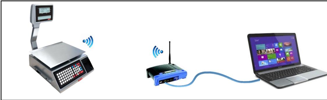
La conexión ETHERNET se hace con un cable de red (RJ45) donde se conecta un modem, la báscula y una computadora.
