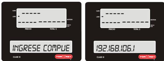
3.2.3.- Por defecto la COMPUERTA es la 192.168.106.1 con las flechas de dirección puede desplazarse entre los dígitos, se dará cuenta en qué posición esta porque el número se mostrara de manera intermitente (aparecerá y desaparecerá) en ese momento puede sustituirlo utilizando el teclado numérico. Para
