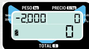
Es importante mencionar que esta función es sustractiva y solo funciona cuando se coloca peso sobre la báscula, por ejemplo: Si tenemos un recipiente que pesa 2.000 kg y la capacidad de la báscula es de 20.000 kg, solamente se podrá pesar hasta 18.000 kg de producto para completar la capacidad máxima.
