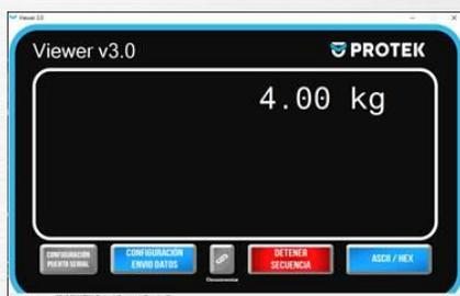
Seleccione la opción “Conectar” y posteriormente la opción “Empezar Secuencia”. Inmediatamente podrá observar en pantalla el peso que coloque en su báscula en tiempo real. Para finalizar la transmisión de datos presione “Detener Secuencia” y después el icono “Desconectar”.
