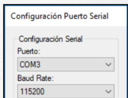
Seleccione “Configuración de Puerto Serial” y elija la velocidad de transmisión y recepción (115200 bps recomendado), así como el puerto al que se conectó la báscula.
