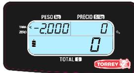
Es importante mencionar que esta función es sustractiva, por ejemplo: Si tenemos un recipiente que pesa 2.000 kg la báscula solamente podrá pesar hasta 28.000 kg de producto para completar la capacidad máxima (30kg). Para cancelar la función de TARA solo presione la tecla "TARA" cuando se muestra el peso negativo del recipiente (al retirarlo de la báscula) y la báscula retornará a la función normal. El indicador de TARA desaparecerá. Las siguientes dos observaciones son de especial importancia:
