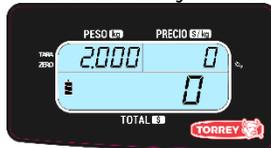
Presione la tecla TARA, el visor/pantalla mostrará ceros y el indicador de TARA y CERO se activarán. Ahora sí coloque el material dentro del contenedor puesto sobre la báscula para ser pesado.
