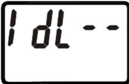
Configuración de auto-off backlight: seleccione entre 0 (desactivado), 5 (5 seg),10 (10 seg), 15 (15 seg), 30 (30 seg) o 60 (60 seg) para configurar el tiempo de apagado de backlight cuando la báscula no se está utilizando.
