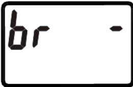
Configuración de intensidad backlight: seleccione entre off (desactivado),1 (bajo),2 (medio.) o 3 (alto para configurar la intensidad de brillo del backlight.
