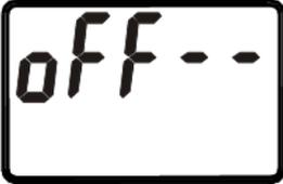
Configuración de auto-off: seleccione entre 0 (desactivado), 5 (5 min), 10 (10min), 15 (15 min), 30 (30 min) o 60 (60 min) para configurar el tiempo de apagado cuando la báscula no se está utilizando.
