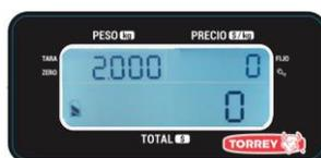
Presione la tecla TARA, el visor/pantalla mostrará ceros y el indicador de TARA y CERO se activarán, ahora sí coloque el material dentro del contenedor puesto sobre la báscula para ser pesado.
