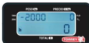
Es importante mencionar que esta función es sustractiva, por ejemplo: Si tenemos un recipiente que pesa 2.000 kg la báscula solamente podrá pesar hasta 18.000 kg de producto para completar la capacidad máxima (20 kg) para cancelar la función de TARA solo presione la tecla "TARA" cuando se muestra el peso negativo del recipiente (al retirarlo de la báscula) y la báscula retornará a la función normal. El indicador de TARA desaparecerá. Las siguientes dos observaciones son de especial importancia:
