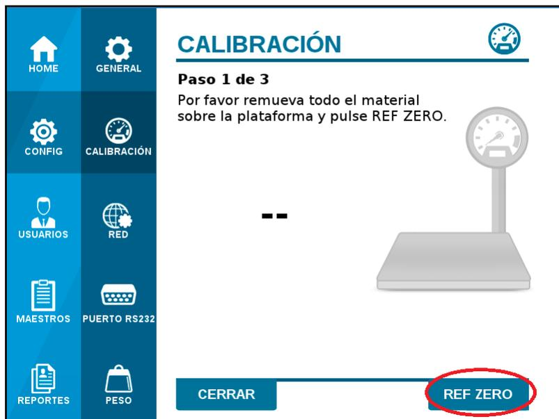
**Imagen 48.** Paso 1 del proceso de Calibración.
