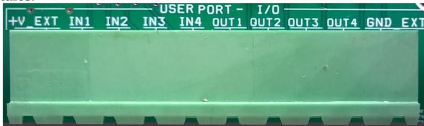
Imagen 8. Puerto conexión de I/O de usuario.
