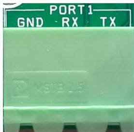
Imagen 10. Puerto conexión serial RS-232
