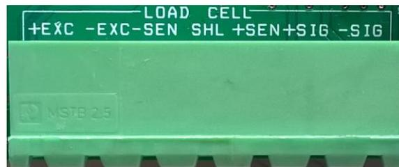
Imagen 4. Puerto conexión Celda de Carga
